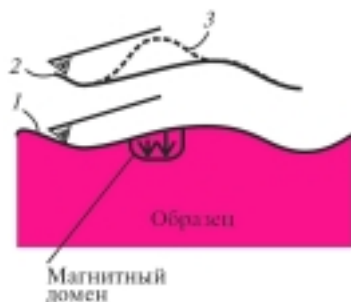
Рис.2. Получение «магнитного» изображения. 1 – запись профиля поверхности с помощью специальной иглы; 2 – при следующем проходе задается та же траектория, но на высоте 10 – 50 нм от поверхности образца; 3 – отклонение иглы от выбранной траектории в результате действия магнитных сил.
