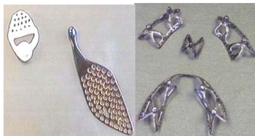
Рис. 7. Имплантанты, покрытые пленкой ЛЦУ.
