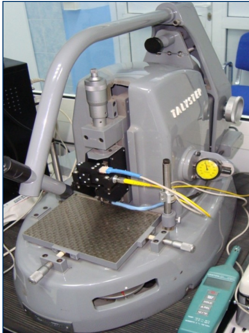
Интерферометр встроенный в профилометр
