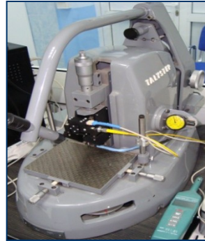
профилометр со встроенным лазерным интерферометром нанотестера, ВНИИМС, Россия
